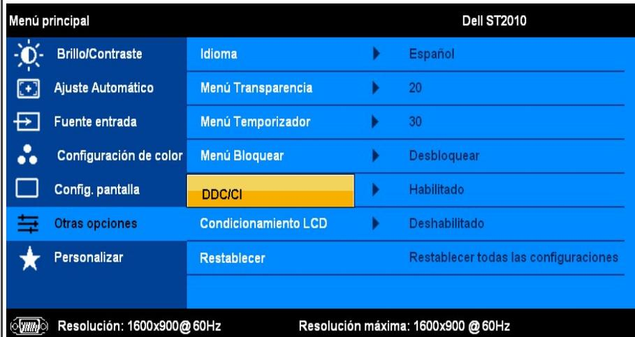
**Acondicionamiento LCD** Le permite reducir los casos menores de retención de imagen. Dependiendo del grado de retención de imagen, el programa podría no ejecutarse. Puede activar esta función seleccionando la opción "Enable" (Habilitar).
